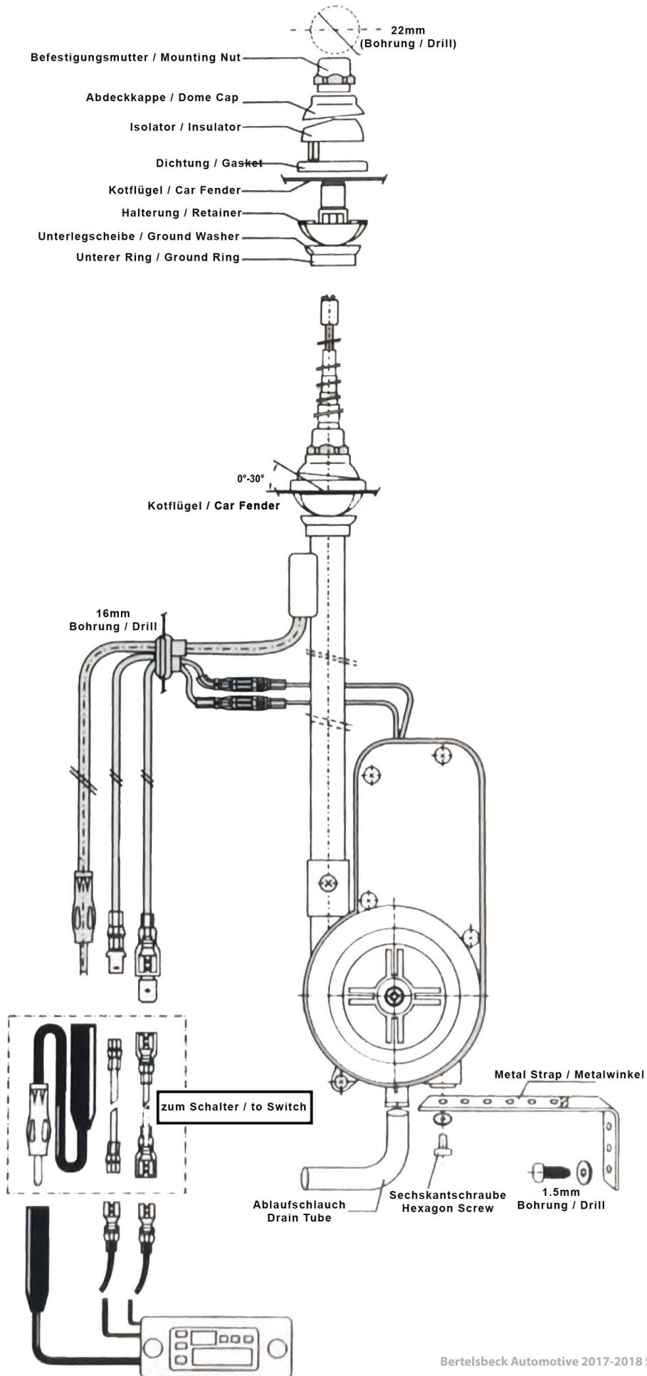
Schließen Sie das rote Kabel an eine positive Stromquelle (+) mit einer 5-Ampere-Sicherung (nicht mitgeliefert) an.
